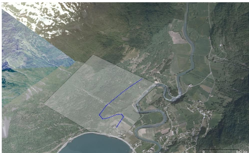
**Bilete:** Ytterlivegen i Skjolden. Vegprosjektet er 100 meter bilveg, velteplass og 1300 meter traktorveg, og er under bygging.
